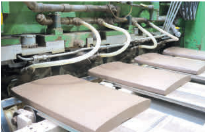
Blick in die Revolverpresse: Beim Pressen wird Wasser aus dem Ton gedrückt, das durch die Oberfläche abgesaugt wird. (Bild: Busch Vacuum Solutions)
