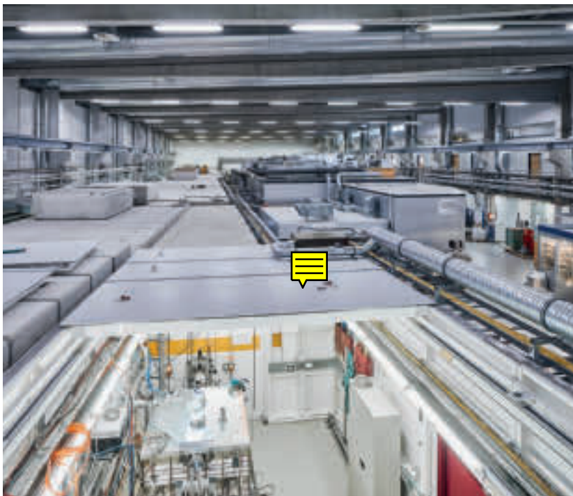
Experimentierhalle des Synchrotrons PETRA III, Hamburg: Die Infrastruktur mit meterdicken Betonabschirmungen und mehreren Strahlführungen ermöglicht laserbasierte Prozesse und Echtzeit-Röntgenanalytik unter extrem strahlungsreichen Bedingungen. (Bild: DESY/D. Altrath)
