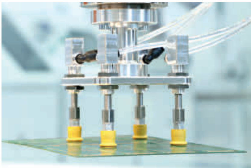
Die Federstößel FSTlmc sind auch mit integrierten Strömungswiderständen und Strömungsventilen verfügbar. (Bild: Schmalz)
