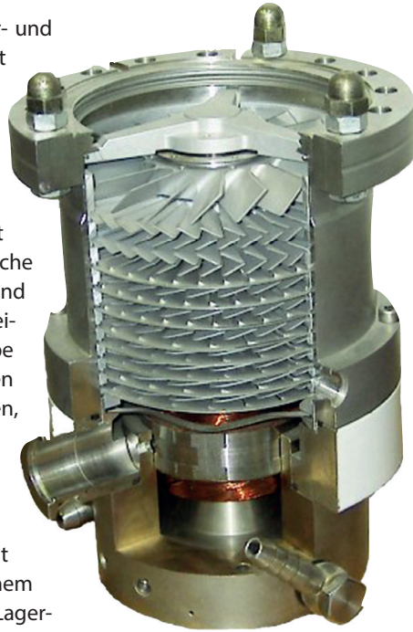
Schnitt durch eine Turbomolekularpumpe (TMP), dieser Pumpentyp wird vielfach in der Hochvakuumtechnik angewendet, kann jedoch bei zu hohen Partikelfrachten und Gaseinbrüchen schnell Schaden nehmen. (Bild: Liquidat, Wikimedia Commons, CC BY-SA 3.0)
