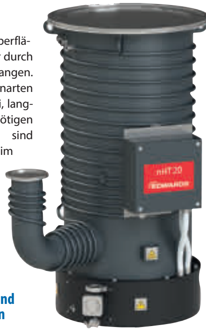
Die Edwards nHT-Serie ist für industrielle Hochvakuumanwendungen konzipiert, je nach Größe reicht ihr He-Saugvermögen von 4.500 - 42.000 l/s, der Betriebsbereich reicht bis 10^{-7} bar. (Bild: Atlas Copco)
