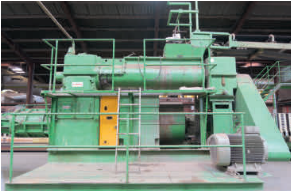
In der Entgasungskammer an der Strangpresse werden Luftblasen und Gase aus dem Ton gesaugt. (Bild: Busch Vacuum Solutions)
