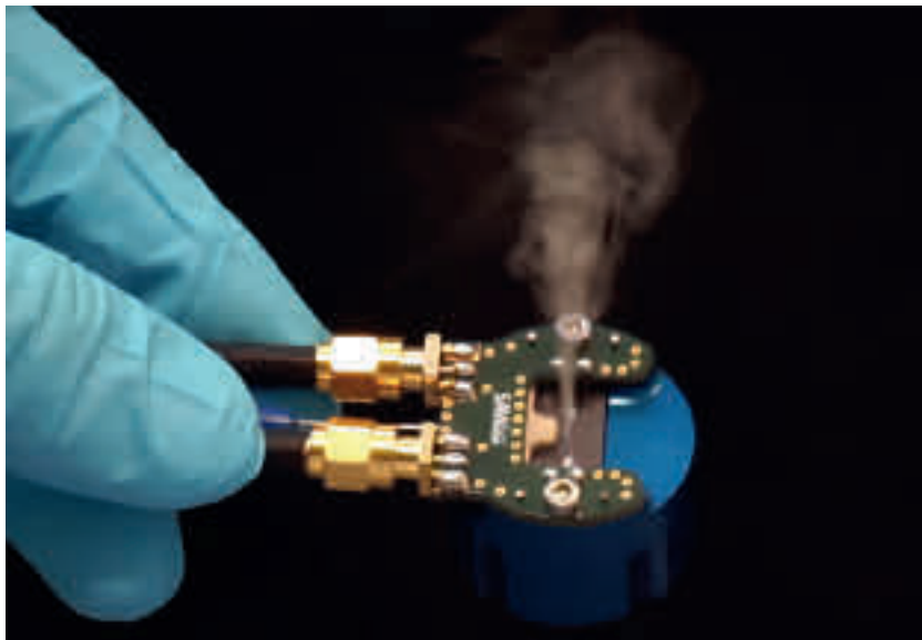
Mikroakustische Aerosolquellen bieten neue Möglichkeiten zum Zerstäuben von Präkursoren in Beschichtungsanwendungen. (Bilder: Leibniz IFW/ Roudini)
