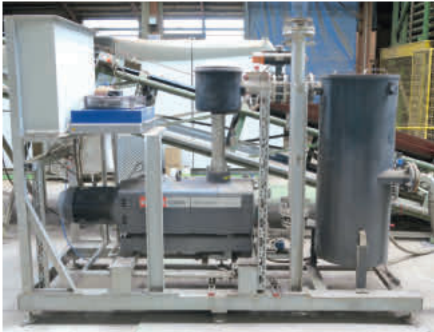
Das vollständige Tonentgasungssystem besteht aus einer Vakuumpumpe Cobra NX, einem Standfilter, einem Steuerschrank, einem Ansaugfilter und einer Kühlwasser-Zirkulationseinheit. (Bild: Busch Vacuum Solutions)
