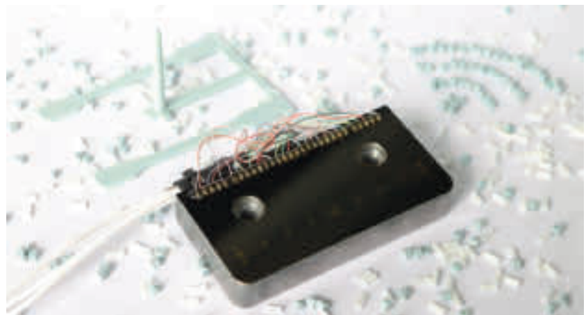
Werkzeugeinleger mit Dünnschichtsensoren für das Kunststoffspritzgießen. (Bild: Fraunhofer IST/Martin Rekowski)
