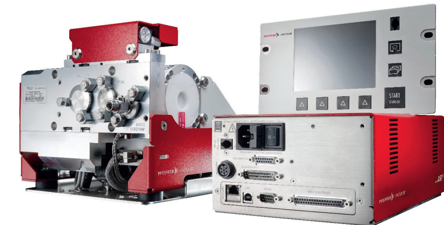
Der modulare Prüfgas-Leckdetektor ASI 35 eignet sich für die Dichtheitsprüfung von Batteriezellengehäusen und lässt sich in industrielle Lecksuchsysteme integrieren. (Bild: Pfeiffer Vacuum+Fab Solutions)
