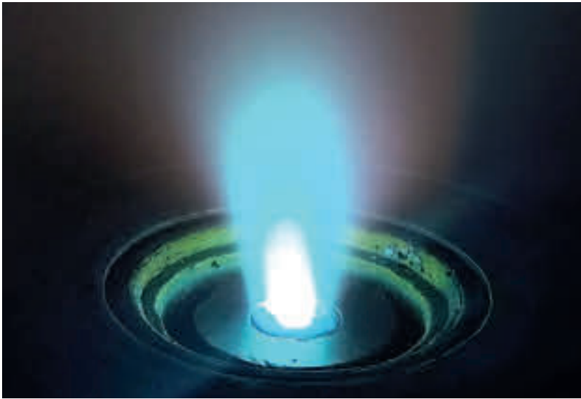
Verdampfung von Cäsiumjodid mit dem anodischen Bogen. (Bild: Fraunhofer FEP)
