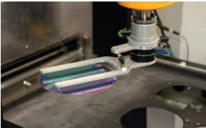
Das Flach-Vakuumgreifsystem, das für die verschiedenen großen Wafer schnell austauschbar ist, hält die beim Beladen der Werkstückträger vorgegebene Positioniergenauigkeit von 0,1 mm ein. (Bild: Azur Space Solar Power)
