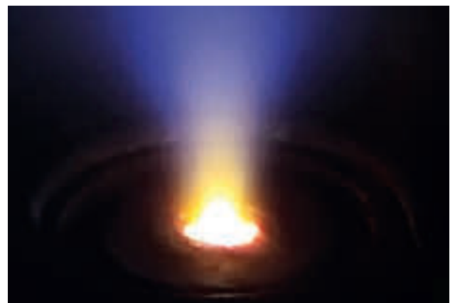
Verdampfung von Zinnoxid mit dem anodischen Bogen. (Bild: Fraunhofer FEP)
