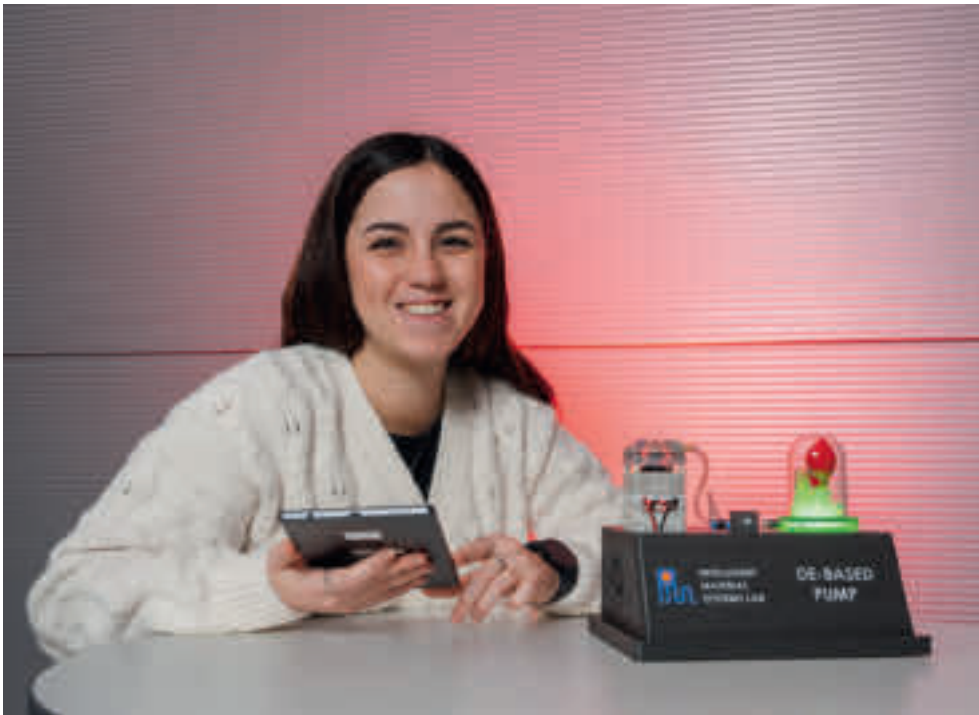
Im Vakuumpumpen-Prototyp zieht eine mit Elektroden beschichtete Silikonfolie ein Vakuum in einer Glasglocke mit Luftballon. Die Doktorandin Carmen Perri forscht an den smarten Pumpen und Ventilen. (Bild: Oliver Dietze)
