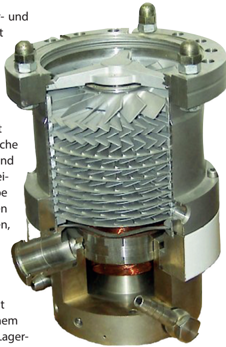
Schnitt durch eine Turbomolekularpumpe (TMP), dieser Pumpentyp wird vielfach in der Hochvakuumtechnik angewendet, kann jedoch bei zu hohen Partikelfrachten und Gaseinbrüchen schnell Schaden nehmen. (Bild: Liquidat, Wikimedia Commons, CC BY-SA 3.0)
