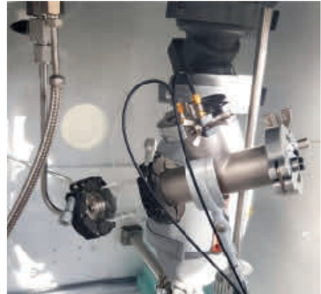
Aufbau für Integrationstests zur Atomlagenabscheidung (ALD) mit der SAW-basierten Aerosolquelle im Vakuumsystem.
