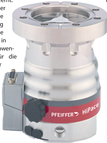
Die tatsächliche Leistung einer TMP hängt von den Einsatzbedingungen ab. Dieses Modell erreicht für N_2 ein Kompressionsverhältnis von 1 \cdot 10^{11} \text{ Pa m}^3/\text{s} und bei Enddrehzahl von 90.000 1/min einen Gasdurchsatz von 1,3 hPa L/s. (Bild: Pfeiffer)
