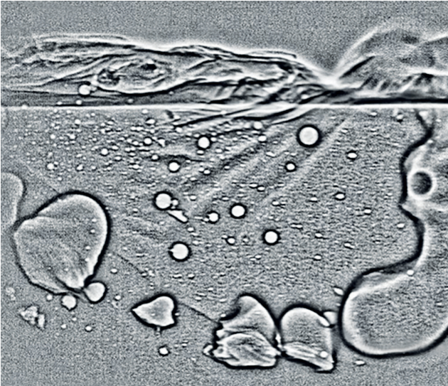
Hochauflösende Echtzeitaufnahme (Phasenkontrast) einer Dampfkapillare im Schmelzbad einer Aluminium-Kupfer-Verbindung: Die entstandene Bildserie (bis 50.000 fps) zeigt mikrometeregenaue Veränderungen der Kapillarform, Schmelzbewegung und Porenentstehung unter industriellen Schweißbedingungen. (Bild: RWTH Aachen – Lehrstuhl für Lasertechnik)
