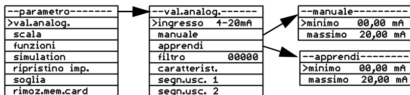
Figura 16: Esempio: selezione segnale in uscita, manuale o apprendimento
