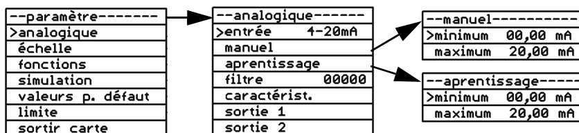
Figure 17: Exemple : Sélectionner le signal d'entrée, manuellement ou par la fonction apprentissage
