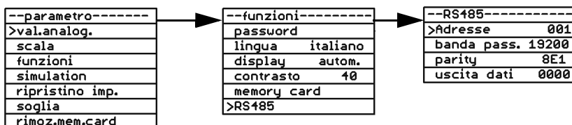
Figura 28: Esempio interfaccia RS485, indirizzo
